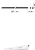
Technische Daten Ledvance LED Deckenleuchte Compact 17W 1900lm - 840 Kaltweiß | 150cm - Ersatz Für 58W
